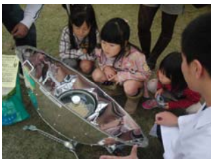
図 10 ソーラクッカーによるポップコーンの調理実験
