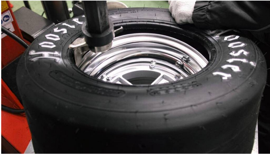
図9 学生フォーミュラ専用のスリックタイヤをホイールに組み付けている様子
