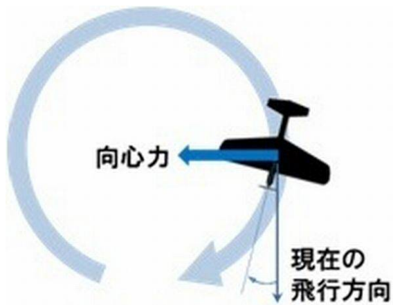
図1 横滑り旋回する機体のイメージ
