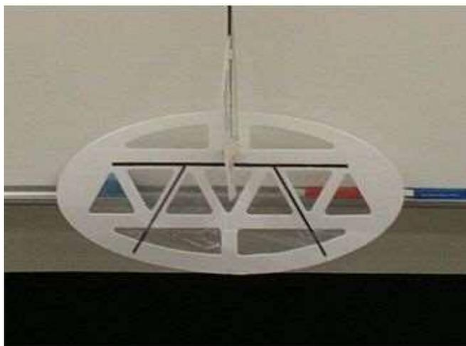
写真1 全遊動式水平尾翼
