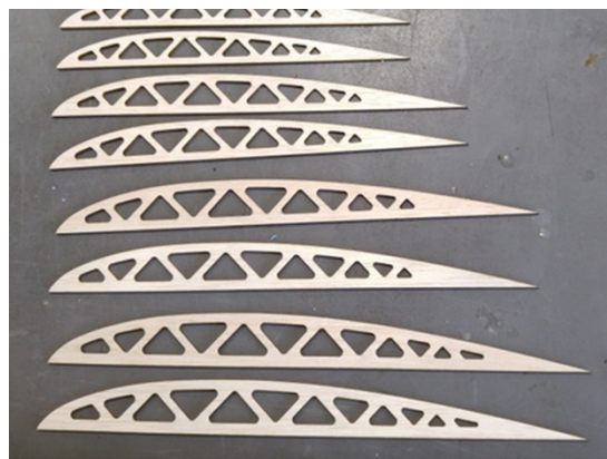
写真4 レーザー加工によって作成されたリブ
