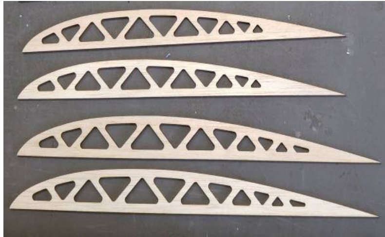
写真4 レーザー加工によって作成されたリブ
