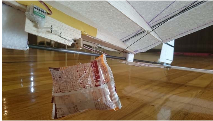
写真7 改良後の投下機構
