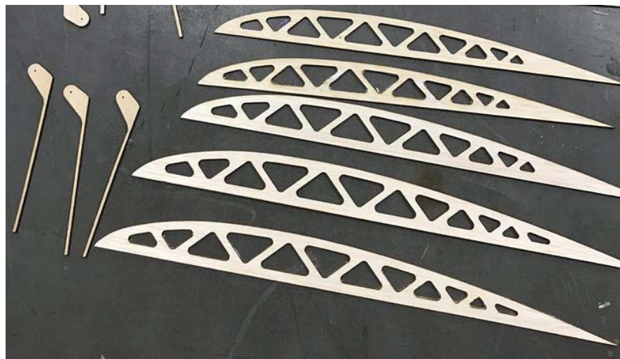
写真 6 レーザー加工で肉抜きしたリブ
