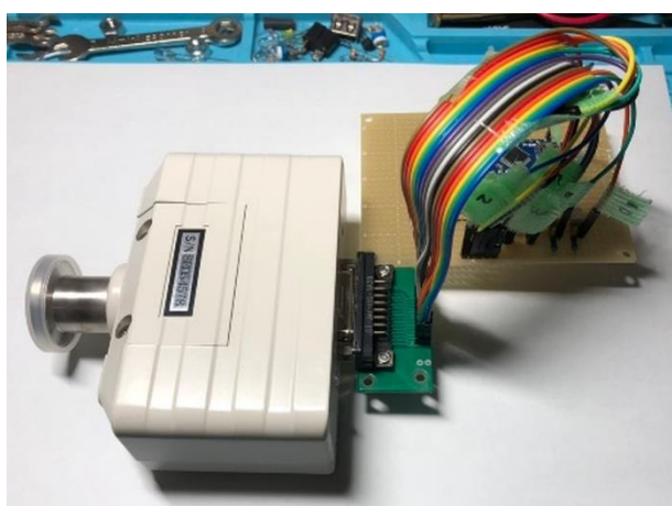
自作した真空度測定用回路
