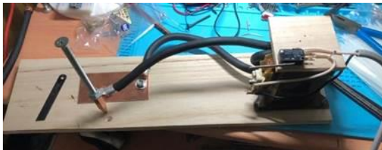
図5 トランスを用いたスポット溶接機
