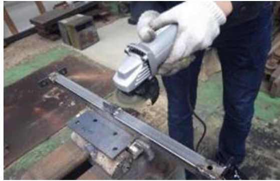
写真8 表面処理（グラインダー）の様子
