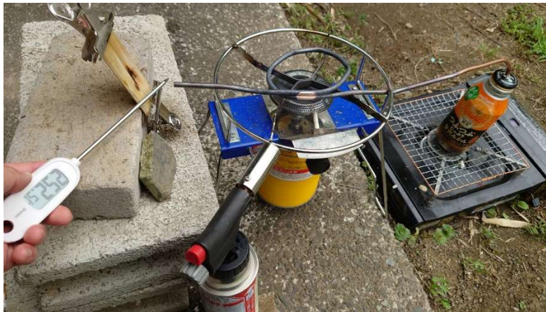
図 4.2 過熱水蒸気発生装置
